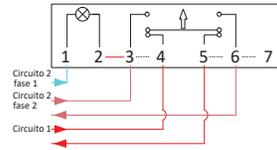
Conexión de muchos dispositivos en serie de contactos que se abren al disparar (Circuito 1) y en paralelo de contactos que se cierran al disparar (Circuito 2), **con chivato en el circuito 2** que muestra que la fuente de alimentación está encendida. **(Los 2 circuitos pueden tener voltajes diferentes).**
