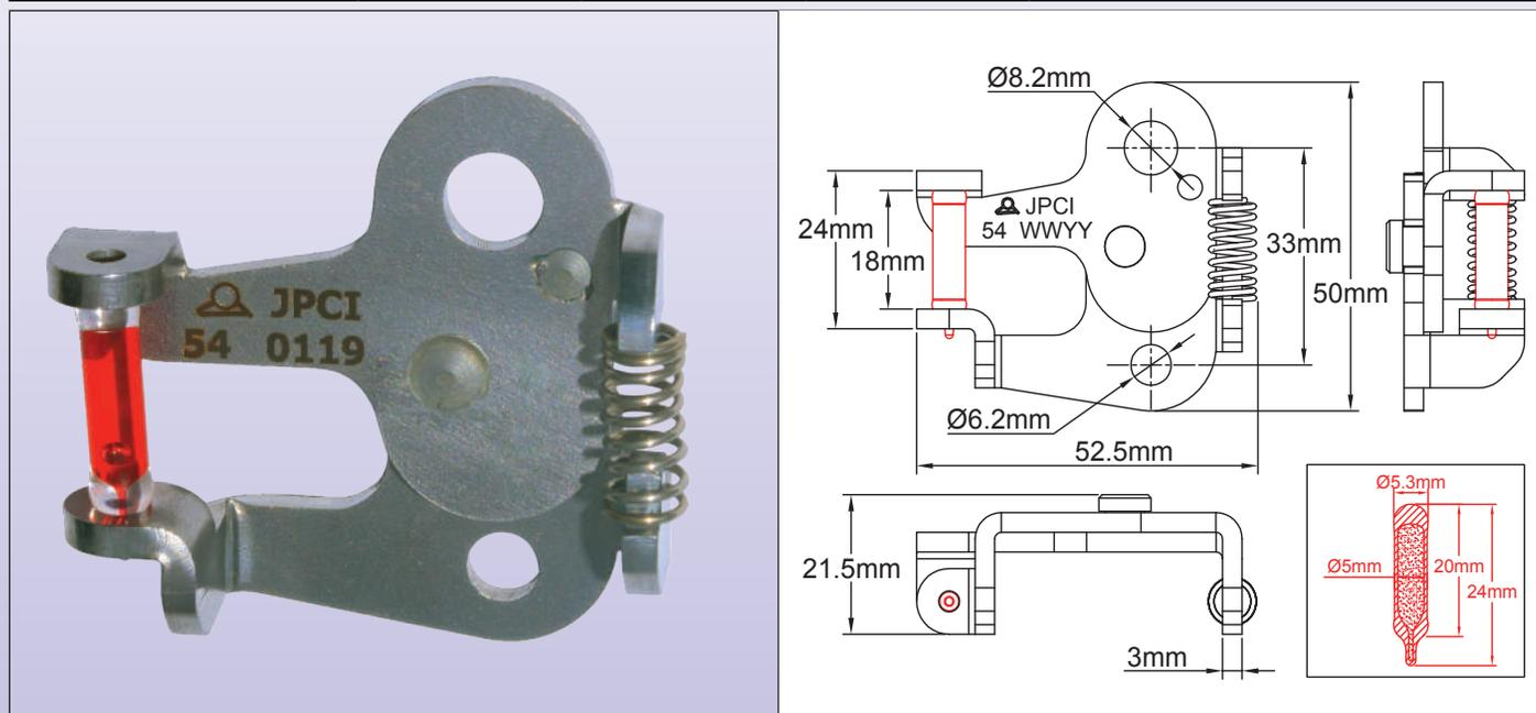
Hechos de acero galvanizado de 3 mm de grosor, estos mecanismos de reducción son compatibles con bulbos de vidrio térmico de 20 × 5 mm. Su enorme coeficiente de multiplicación reduce la fuerza aplicada al bulbo de vidrio térmico a solo el 15 % de la aplicada al mecanismo. El reemplazo del bulbo de vidrio es sencillo y se puede realizar sin herramientas especiales. Resisten la sobrecarga de 300 DaN durante 5 minutos y una carga mínima de 0,4 DaN.
