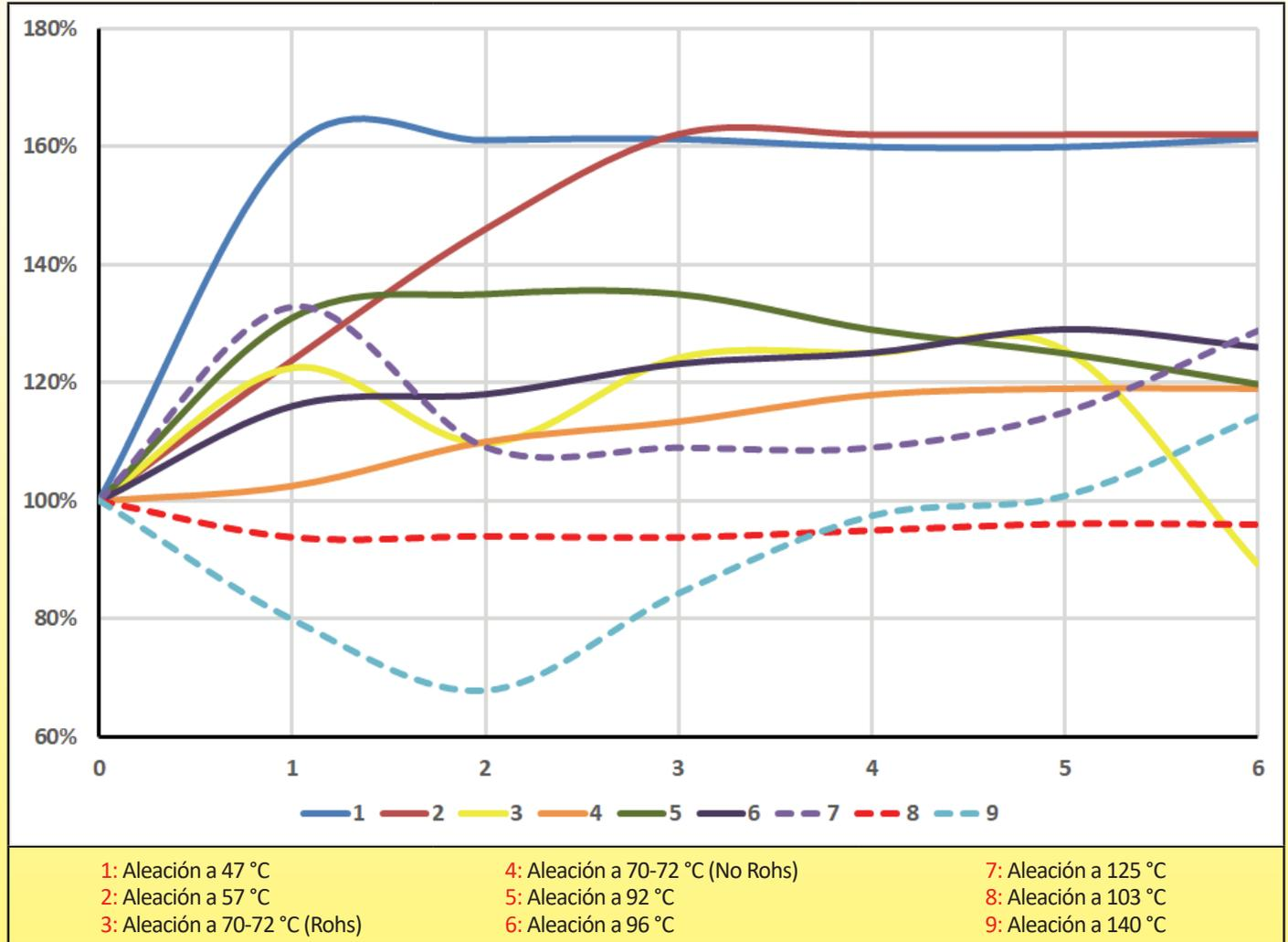
La curva anterior representa la variación de la resistencia, en % del valor medido inmediatamente después de la soldadura, durante 6 semanas, de especímenes de prueba soldados, utilizando una superficie de soldadura de 225 mm<sup>2</sup>, hechos con varias aleaciones fusibles. Valores medidos en nuestro propio equipo de pruebas a una velocidad lenta de tracción de 0,05 mm/min.
